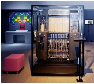
Гидроинтегратор В. Лукьянова. Водяная аналоговая ЭВМ, 1936 г
